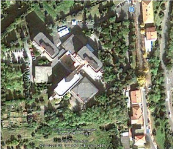
Tutti gli edifici sono realizzati con struttura in cemento armato e muratura. L'accesso agli edifici della struttura è garantito da due cancelli carrabili affiancati ed indipendenti posti su Via da Filicaia. Intorno alla struttura gira una strada asfaltata che permette di raggiungere agevolmente tutti gli edifici anche con mezzi pesanti.
