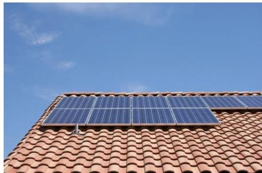
Questa azione prevede l'installazione di impianti fotovoltaici per la produzione di elettricità sulle abitazioni esistenti del territorio comunale. Vista l'età del parco edilizio, e l'orientamento delle falde, si stima un tasso del 70% di falde delle abitazioni sfruttabili installando impianti da 3 kWp ad abitazione.
